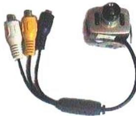
Gambar 2 Kamera warna CMOS
