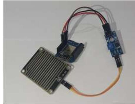
Gambar 4. Pemasangan Wemos D1 Mini dengan Sensor Raindrop
