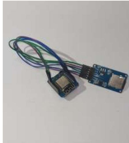
Gambar 5. Pemasangan Wemos D1 Mini dengan Data Logger
