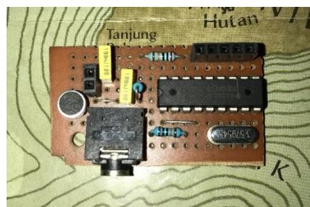
Gambar 5. Rangkaian DTMF Decoder IC MT8870
