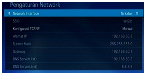
Gambar 5. Konfigurasi Alamat IP Decoder Kaonsat
